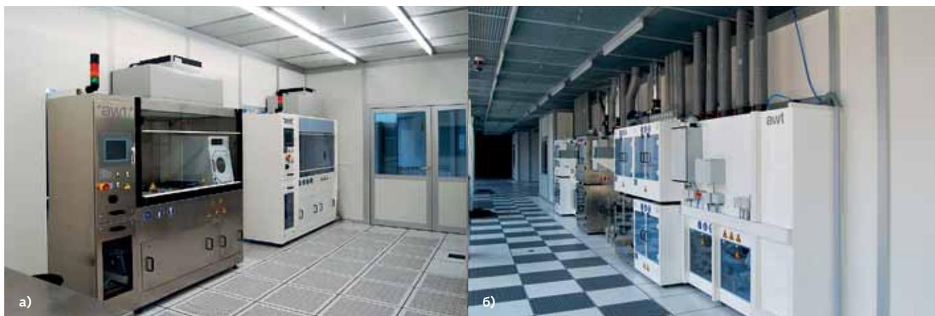
**Рис.2.** Размещение технологического оборудования: а) вид со стороны чистого помещения; б) вид со стороны серой зоны
