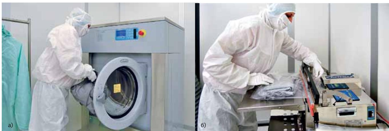
Рис.10. Прачечная для особо чистой одежды: а) процесс стирки; б) процесс вакуумной упаковки
