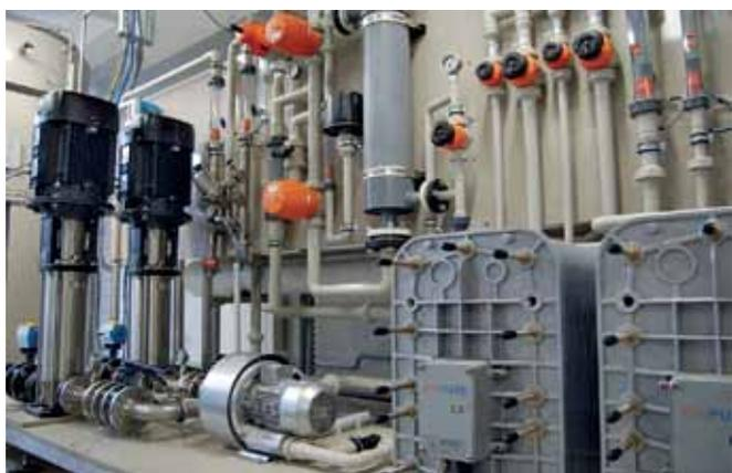
**Рис.4.** Система подготовки и распределения деионизованной воды
