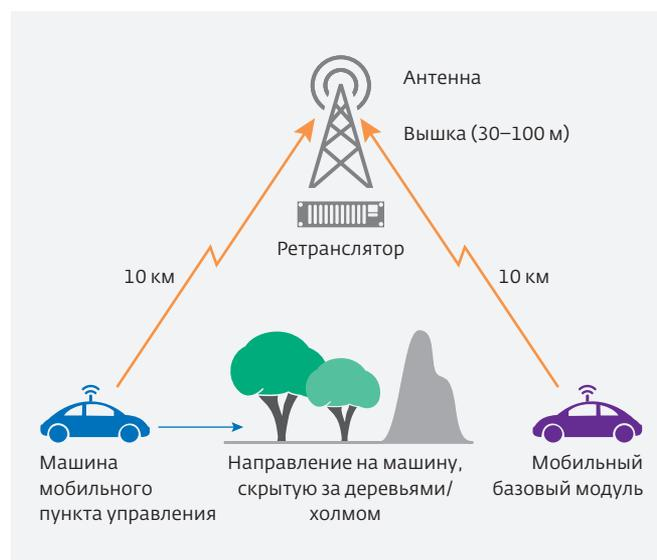
**Рис.2.** Принцип взаимодействия элементов в составе комплекса UGV
