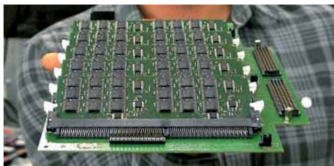
Рис.5. Опытный образец платы PCM-памяти
