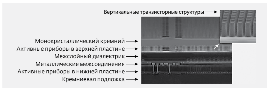
Рис.4. Трехмерная структура интегральной схемы компании BeSang
