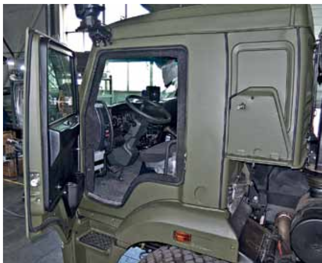
Бронированная кабина производства "АСТЕЙС" с приборной панелью производства "Икар Плюс"
