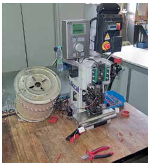
Готовые к использованию аппликаторы (слева); пресс компании Mecal с контролем усилия опрессовки (справа)
