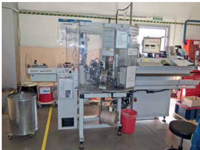
Автоматическая линия Gamma 333. Она позволяет обжимать два провода одним контактом (справа)
