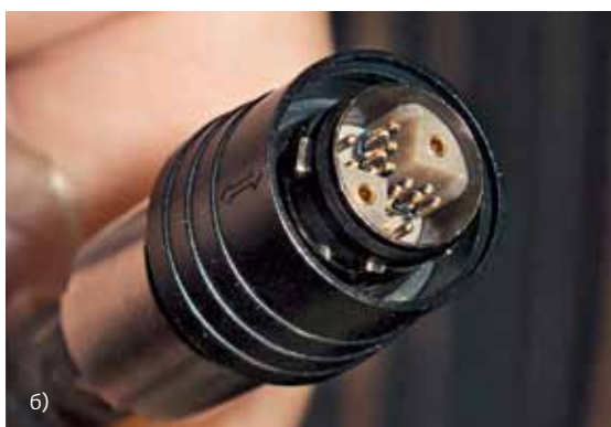
Разъем серии Fischer MiniMax компании Fischer Connectors (а-в), собранный из 3D-MID-деталей (г)
