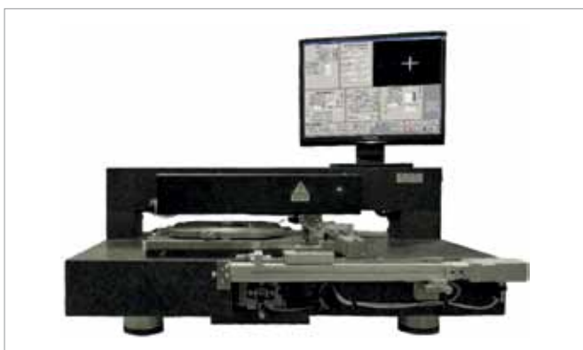
Рис.11. Установка для формирования меток на непла-нарной стороне ЭМ-5186
