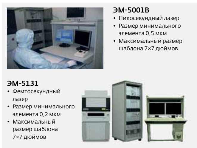
Рис.13. Лазерные установки для устранения дефектов фотошаблонов: ЭМ-5001В (а) и ЭМ-5131 (б)
