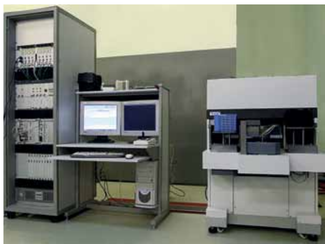
Рис.8. Установка автоматического контроля микродефектов на пластинах с топологией ЭМ-6429Б
