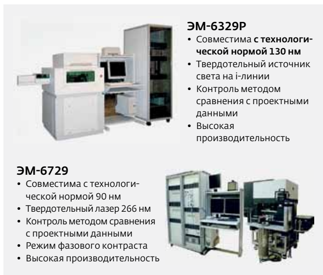
Рис.12. Установки для контроля фотошаблонов: ЭМ-6329Р (а) и ЭМ-6729 (б)
