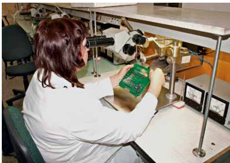
Участок ремонта. Используется "воздушный паяльник" собственного изготовления
