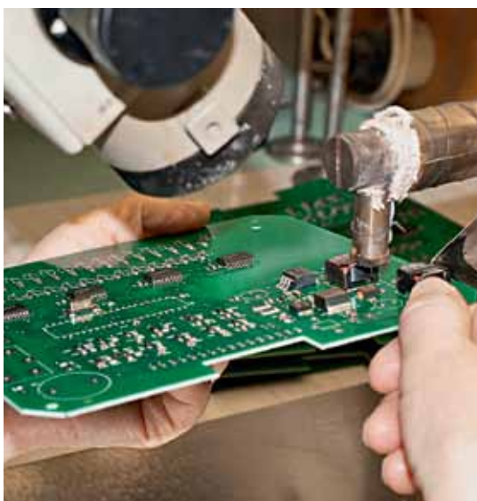
Участок ремонта. Используется "воздушный паяльник" собственного изготовления
