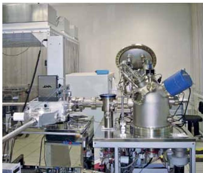
**Рис.13.** Внешний вид электронного спектрометра высокого разрешения
