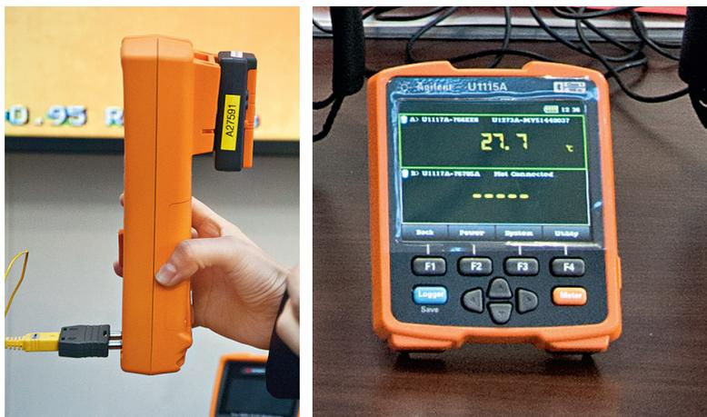
Система беспроводной передачи данных по стандарту Bluetooth Class 1 - адаптер ИК-Bluetooth U117A (слева) и беспроводной терминал U115A (справа)
