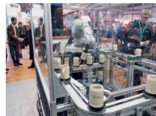
Робот наносит надписи на пивные кружки
