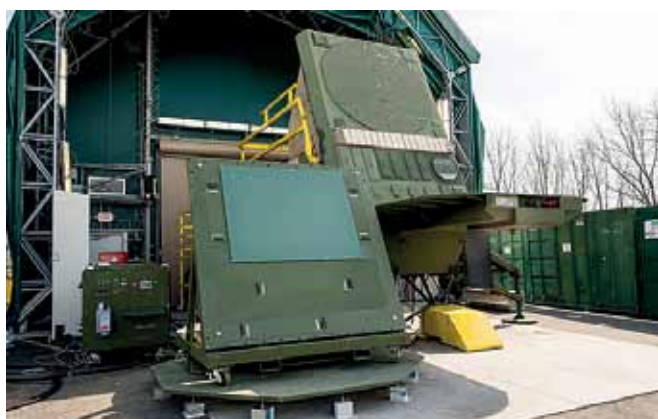
Рис.5 Комплекс ПВО/ПРО Patriot с РЛС с АФАР, модернизированный на основе GaN-приемопередающих модулей
