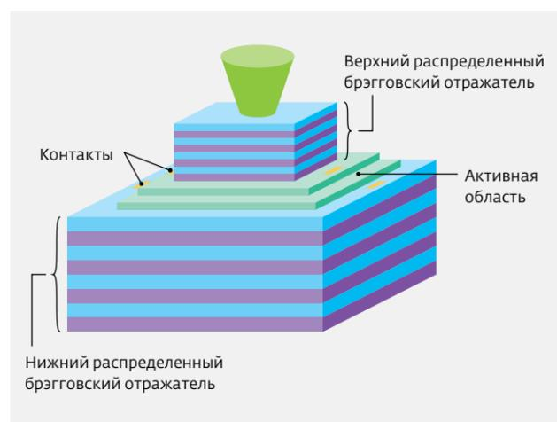
Рис.3. Конструкция кристалла длинноволнового VCSEL
