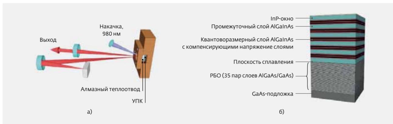
**Рис.27.** Длинноволновый VECSEL-SESAM: а) схема Z-образной конфигурации с использованием оптической накачки; б) конструкция УПК
