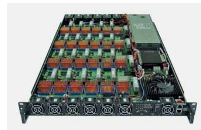
Рис.3. Базовый модуль "24 V7-750", содержащий четыре платы "Плеяда"
