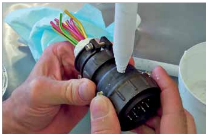
Рис.5. Заливка разъема серии ШР Виксинтом У-1-18 из Dopaq Metamix
