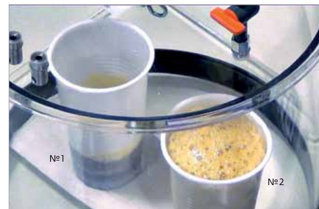
Рис.2. Результат вакуумирования образцов ВК-9, полученных на оборудовании Dorag Eldomix (№ 1) и вручную (№ 2)
