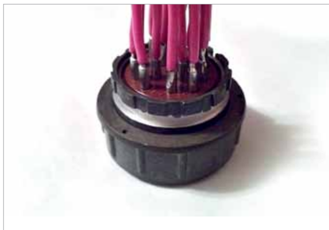
Рис.4. Разъем серии ШР после распайки и обработки
