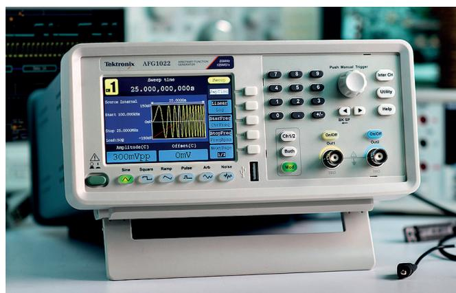
Рис.1. Генератор сигналов произвольной формы Tektronix AFG1022
