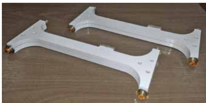
Рис.1. Сумматоры мощности на основе волноводного моста
