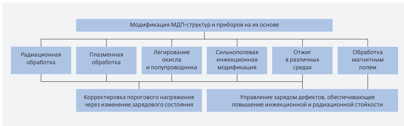
Рис.1. Основные способы управления параметрами МДП-структур
