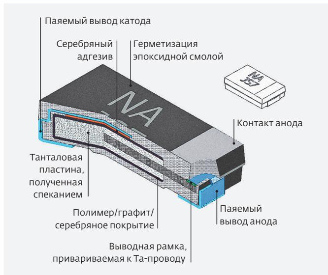
**Рис.5.** Структура полимерного танталового конденсатора компании Vishay
