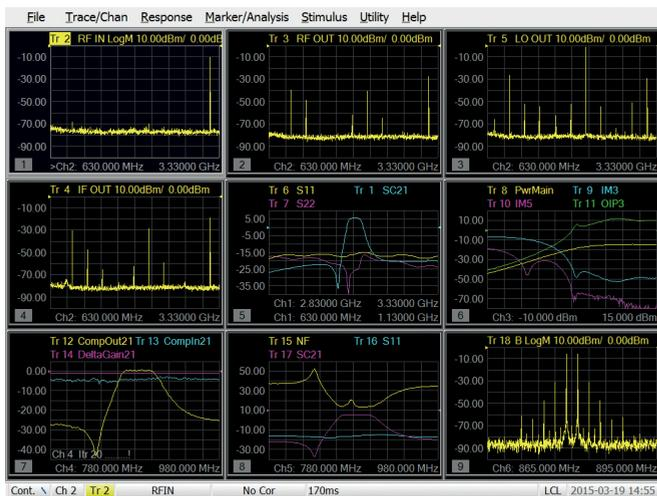
Рис.1. Интерфейс векторного анализатора цепей PNA в режиме одновременного измерения спектра на нескольких портах
