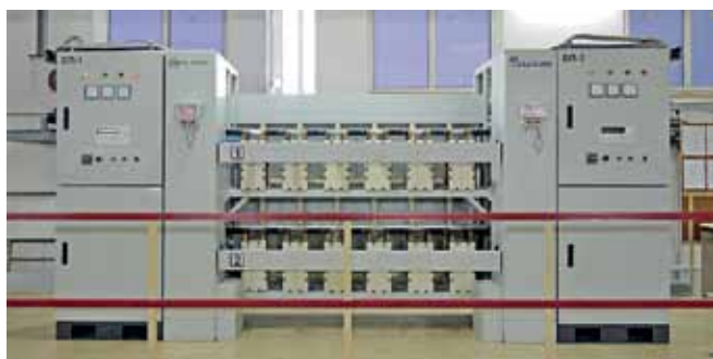
Рис.3. Электролизная установка Э-5. Производительность 120 кг/сутки по активному хлору в гипохлорите натрия
