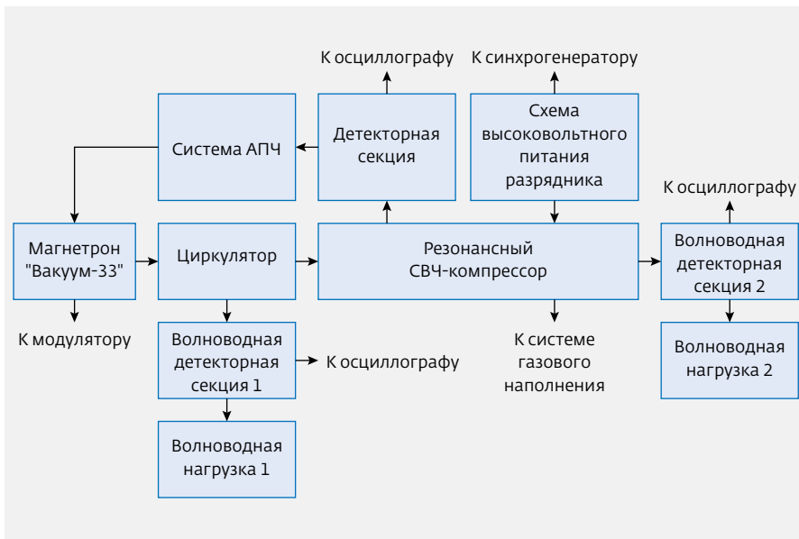
Рис.1. Упрощенная структурная схема генераторного СВЧ-модуля
