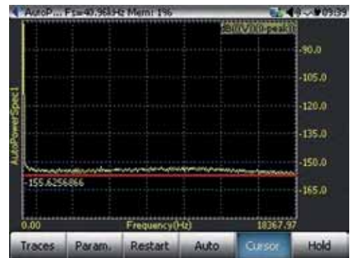
Рис.4. Измерение уровня собственного шума в частотной области на основе метода БПФ
