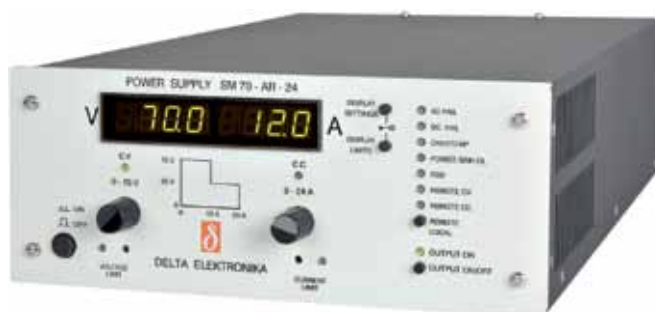
Рис.2. Источник питания постоянного тока 800 Вт серии SM 800
