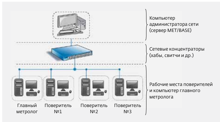
Рис.3. Пример организации сети для работы Fluke MET/CAL
