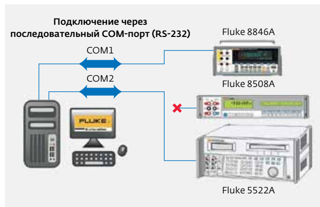
Рис.2. Полуавтоматическая поверка СИ (один из возможных вариантов коммутации)
