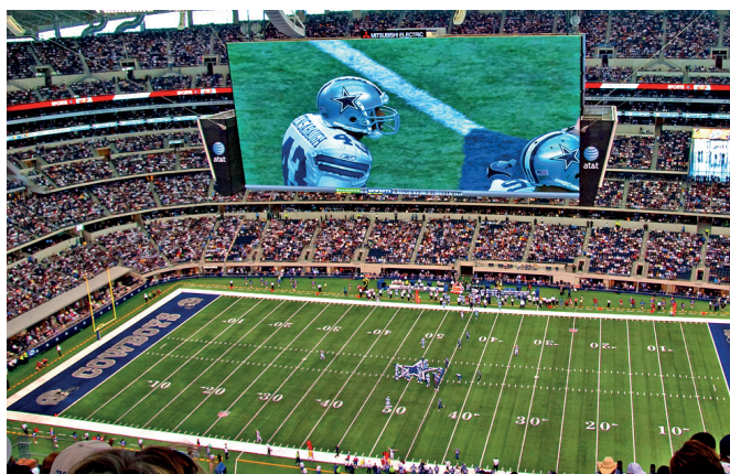
Рис.3. Экран высокого разрешения, установленный на стадионе в г. Арлингтон (штат Техас, США). Размеры главных дисплеев – 22×49 м
