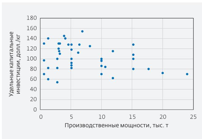
Рис.7. Распределение удельных инвестиций в действующие производства поликремния в зависимости от объема выпуска
