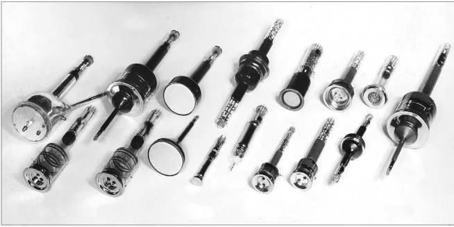
Рис.5. Преобразовательные запоминающие ЭЛП
