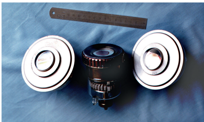
Рис.13. ИПЛЭН (импульсные полупроводниковые лазеры с электронной накачкой)
