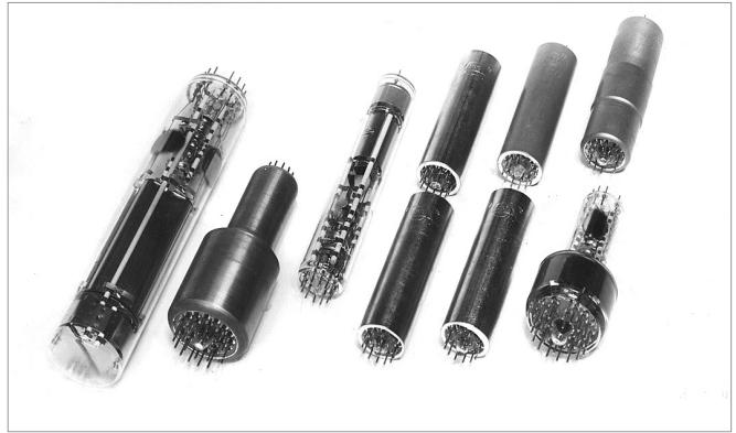
Рис.7. Функциональные ЭЛТ серии ЛФ
