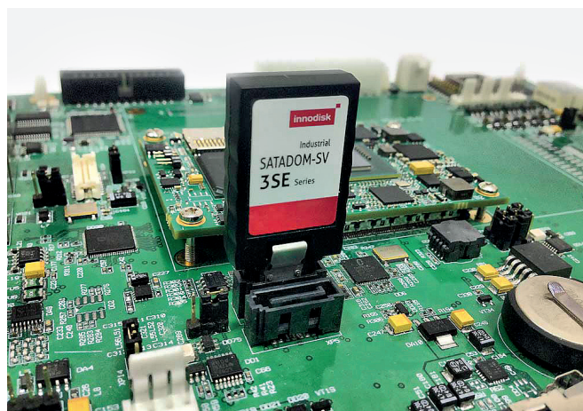
Рис.3. Накопитель SATADOM с технологией питания Pin 7 VCC
