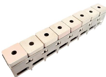
Рис.1. Полосовой керамический фильтр CBPF915H23-DIP для центральной частоты 915 МГц
