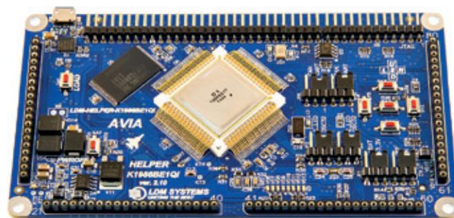
Рис.6. Master-модуль LDM-HELPER-K1986BE1QI с микросхемой 1986BE1T
