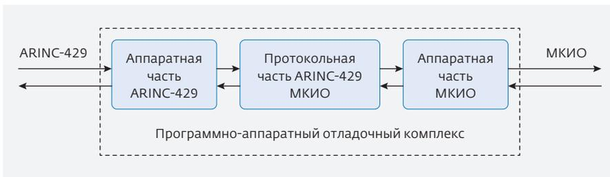
Рис.3. Блок-схема программно-аппаратного отладочного комплекса для организации интерфейса ARINC-429 и МКИО
