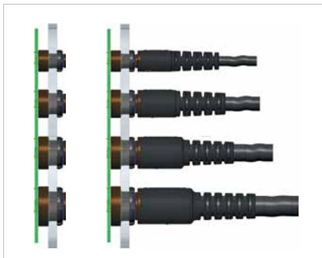
Рис.7. Выравнивание разъемов ODU AMC HD разных размеров при монтаже
