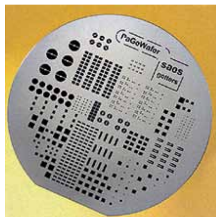
Рис.9. Кремниевая пластина фирмы SAES Getters со сформированным рисунком тонкопленочного геттера для корпусирования на уровне пластины
