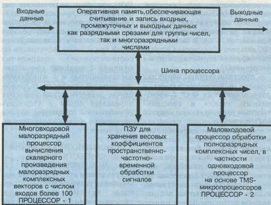
Рис. 1. Основные блоки устройства цифровой обработки сигналов
