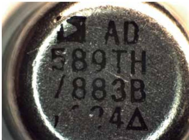
**Рис.3.** Контроль качества маркировки. После протирки спирто-бензиновой смесью отдельные символы маркировки частично стерлись
