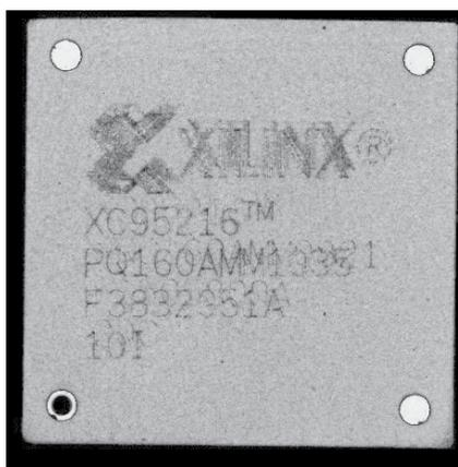
**Рис.4.** Следы перемаркировки на пластмассовом корпусе, выявленные методом акустической микроскопии
