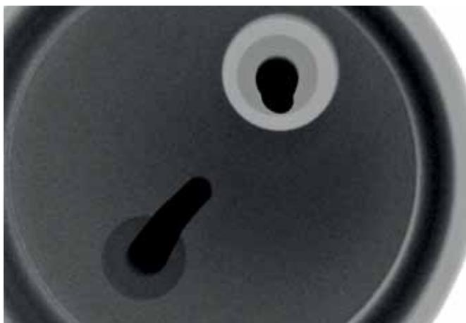
**Рис.1.** Рентгеновский контроль. Отсутствие кристалла в корпусе микросхемы
