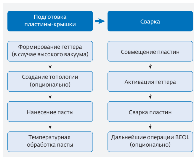
Рис.2. Основные этапы сварки пластин стеклокерамическим припоем. BEOL (back end of line) – конечный этап изготовления схемы
