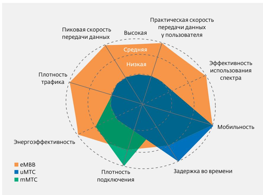
Рис.1. Сценарии использования 5G-систем в 2020-м, предложенные ITU. Источник – ITU-R M. (IMT.VISION)
