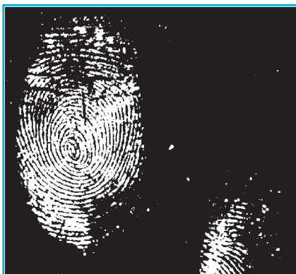
Рис. 2. Фотография лазерно-люминесцентного изображения отпечатка пальца на поверхности дерева, полученного без предварительной обработки
