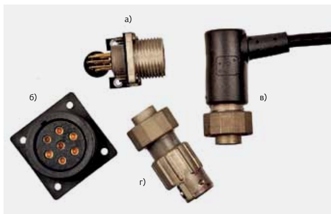
Рис.22. Цилиндрический герметичный разъем серии Front Runner: часть разъема с гнездовыми контактами и выводами для установки на плату под углом 90^\circ (а, б) и "ответная" часть разъема со штыревыми контактами и гайкой для обеспечения резьбового сочленения (в, г)
