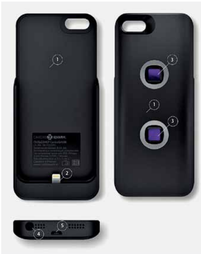
Рис.4. Внешний вид кардиомонитора CardioQVARK: 1 – корпус, 2 – разъем Apple Lightning для соединения с iPhone, 3 – датчики EPG, 4 – порт для наушников, 5 – порт MicroUSB
