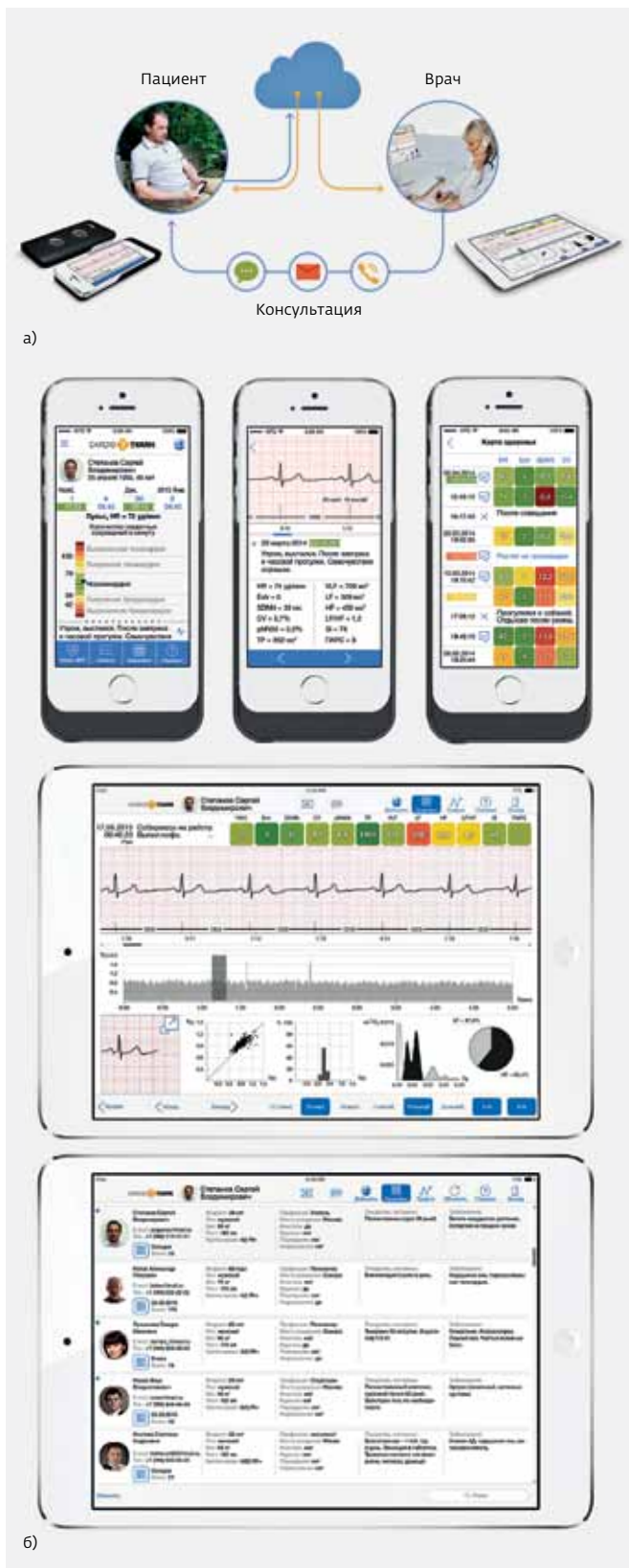
Рис.6. Диагностическая система CardioQVARK: а) принцип действия, б) образцы информационных окон ПО CardioQVARK на экране смартфона и планшетного компьютера
