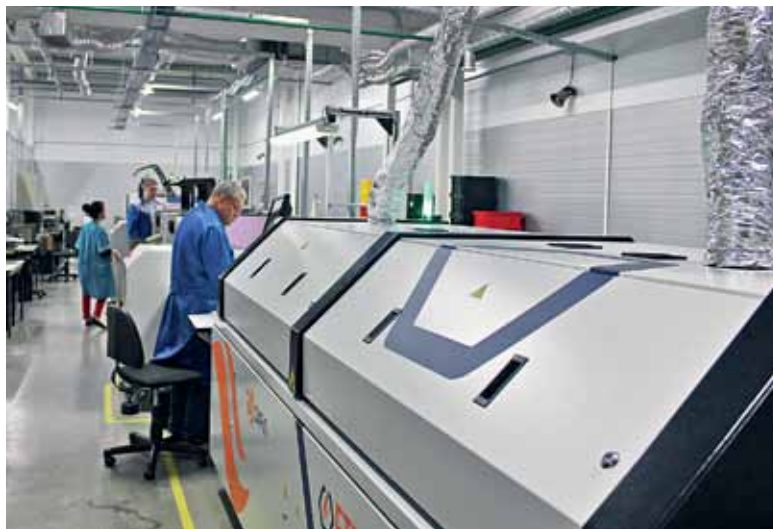
Автоматизированная линия поверхностного монтажа печатных плат
