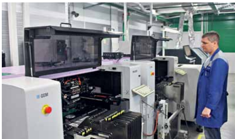
Автомат для установки электронных компонентов
