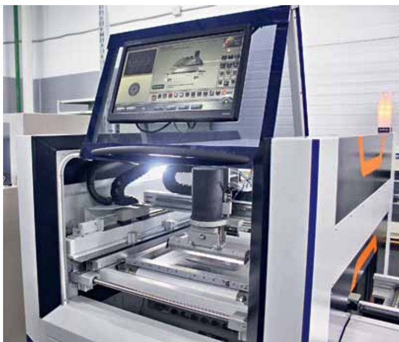
Автоматический принтер трафаретной печати "БУРАН-В100" для нанесения паяльной пасты
