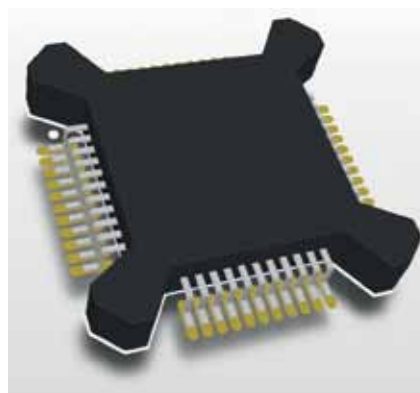
Рис.8. 3D-модель компонента, созданная в IPC Compliant Footprint Wizard
