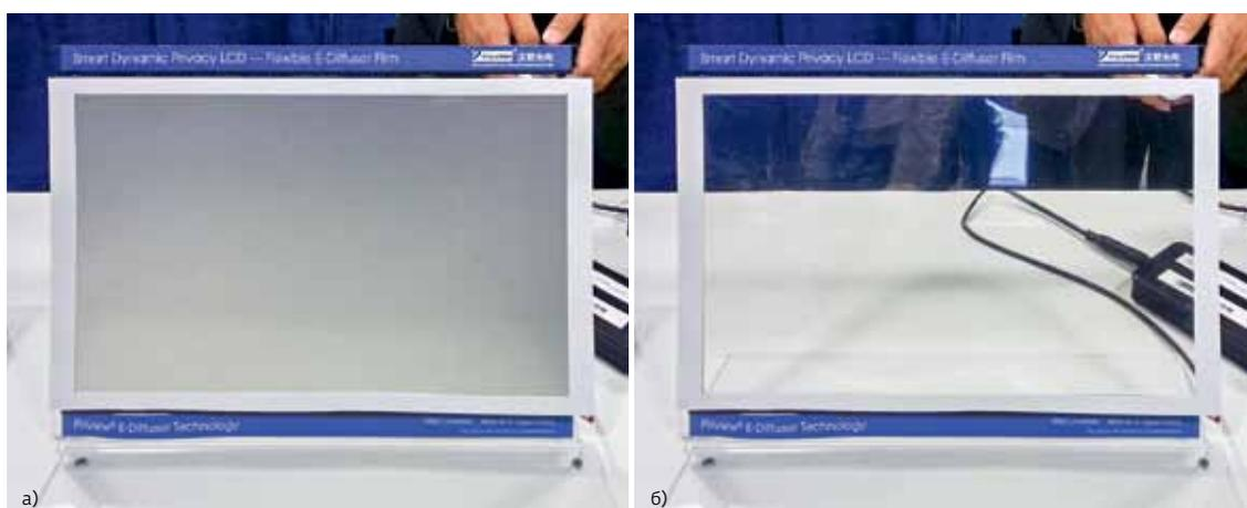
**Рис.10.** Умный ЖК-дисплей для динамической приватности в светорассеивающем (а) и прозрачном (б) состояниях. Он может использоваться и как гибкий пленочный электронный диффузер
