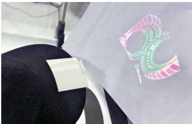
Рис.2. Проекционное устройство CYCLOPS компании CY Display (США) закреплено на бейсболке. Пикопроектор создает изображение перед пользователем
