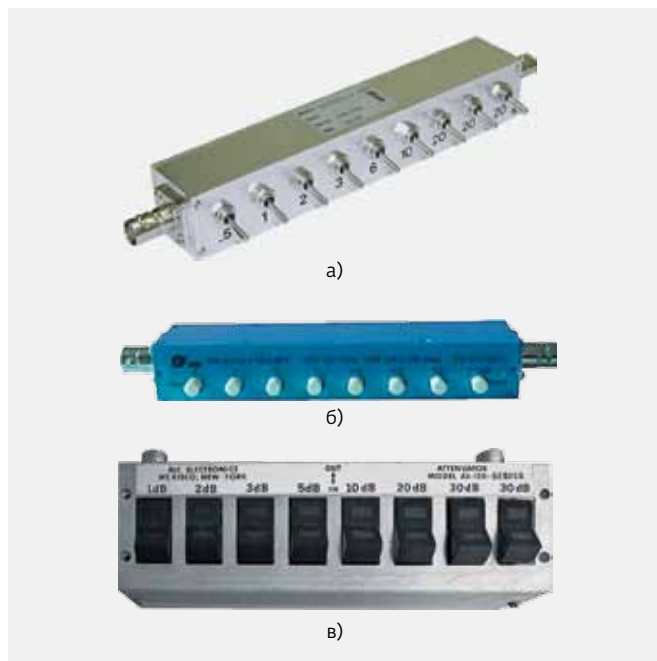
Рис.3. Коаксиальные аттенуаторы с ручным управлением: а – тумблерами, б – кнопками; в – клавишами
