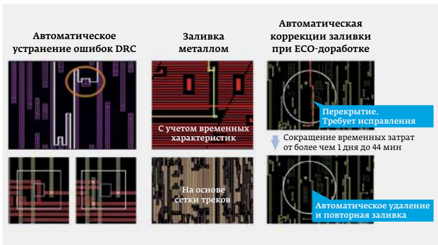
Рис. 8. Возможности совместной работы IC Validator и IC Compiler II
