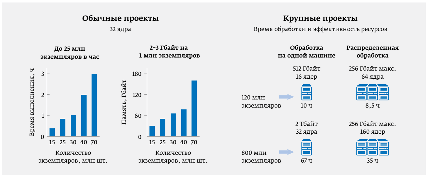
Рис. 6. Зависимость скорости работы PrimeTime от размера проекта и используемых аппаратных ресурсов
