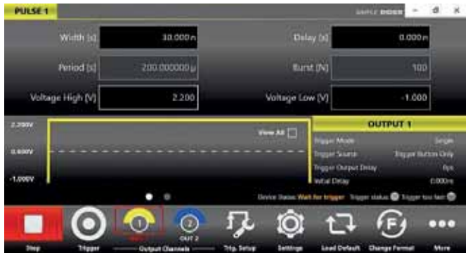
Рис. 9. Меню установки параметров импульсов генератора АК ИП-3309 в режиме коротких импульсов: смещение -1 В, амплитуда 3,2 В, ширина импульса 30 нс, однократный запуск
