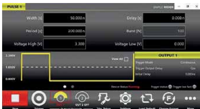
Рис. 2. Меню установки параметров импульсов генератора АКИП-3309 для записи-стирания одной ячейки: длительность 50 нс, амплитуда 3,3 В
