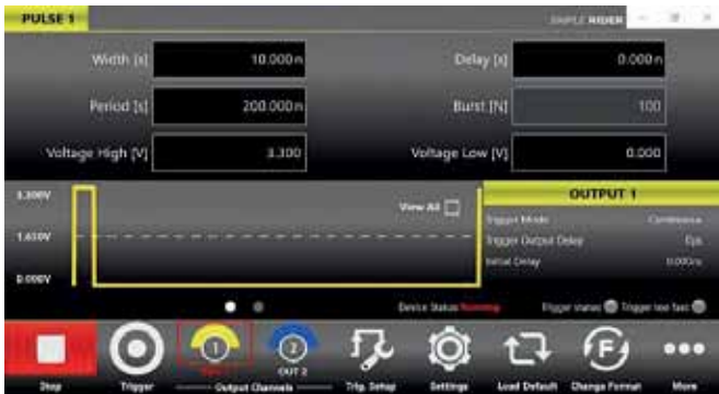
Рис. 5. Меню установки параметров импульсов генератора АКПП-3309: импульс сброса 10 нс / 3,3 В
