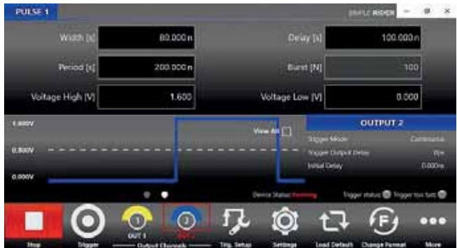
Рис. 6. Меню установки параметров импульсов генератора АКПП-3309: импульс установки 80 нс / 1,6 В
