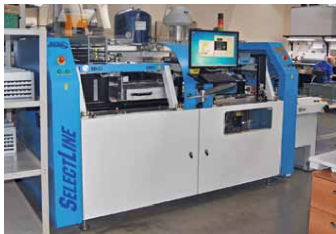
Установка селективной пайки SelectLine-C от SEHO Systems GmbH
