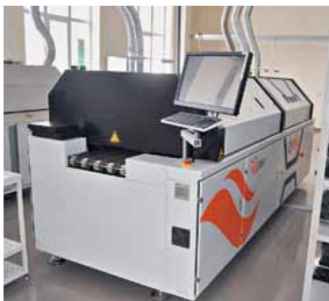
Конвекционные печи пайки оплавлением на производстве
