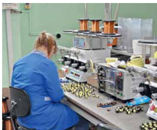
Намотка трансформаторов: автоматическая (слева) и полуавтоматическая (справа)
