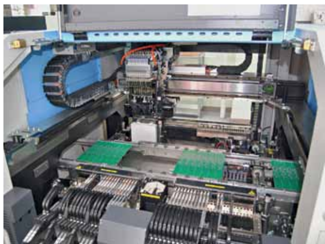
Внутреннее пространство чип-шутера Yamaha Motor IM YS12
