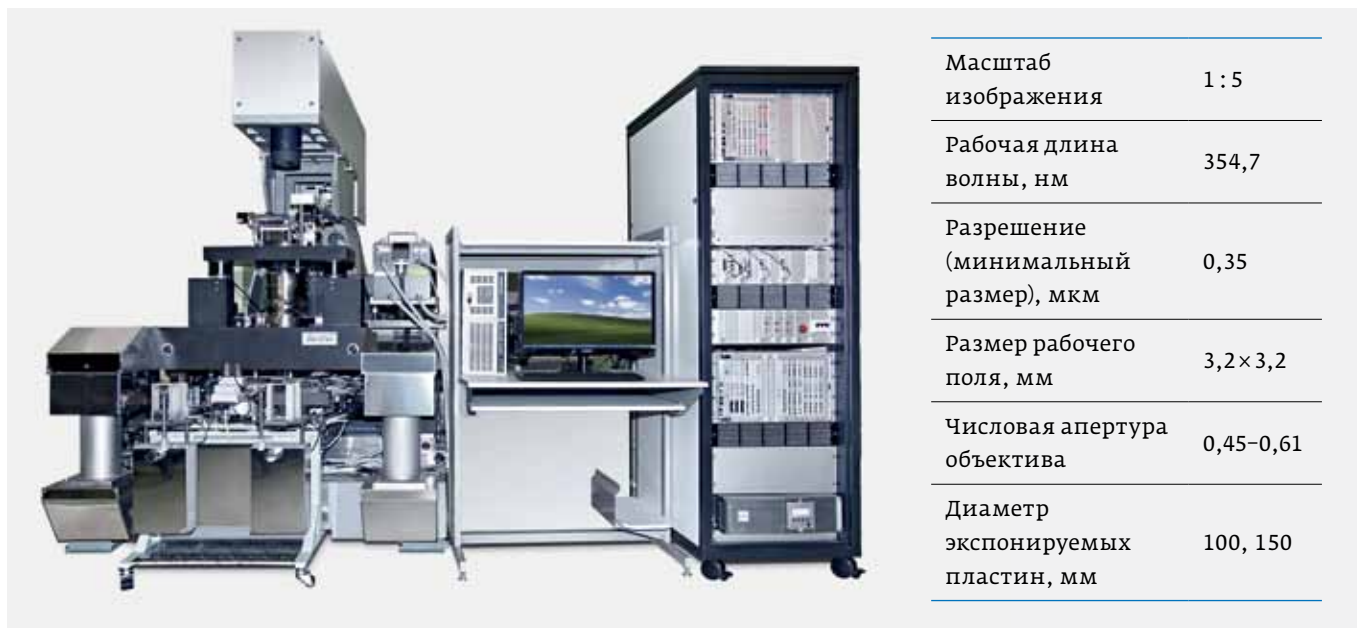
Рис. 1. Установка совмещения и экспонирования ЭМ-5784 и основные технические параметры степпера
