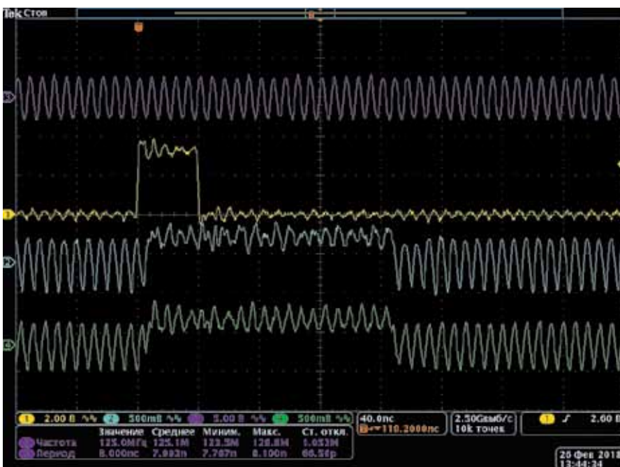
Рис. 6. Осциллограмма процесса синхронизации двух независимых тактовых разветвителей
