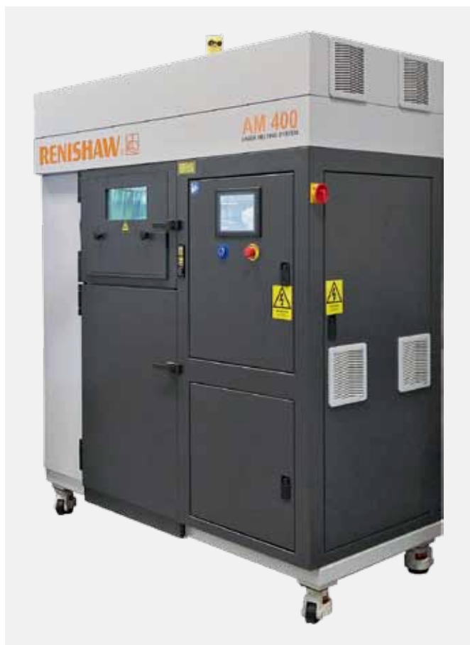
Рис. 11. Установка селективного лазерного сплавления Renishaw AM400 в лаборатории ООО «Остек-СМТ»
