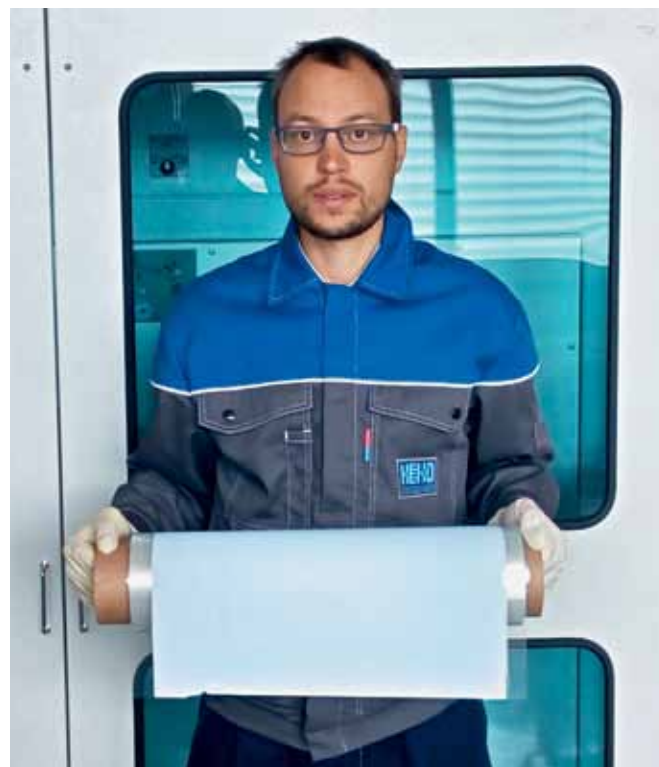
Рис. 1. Один из ведущих специалистов КЕКО Equipment, Костя Макарович, представляет LTCC-ленту шириной 425 мм и толщиной 100 мкм
